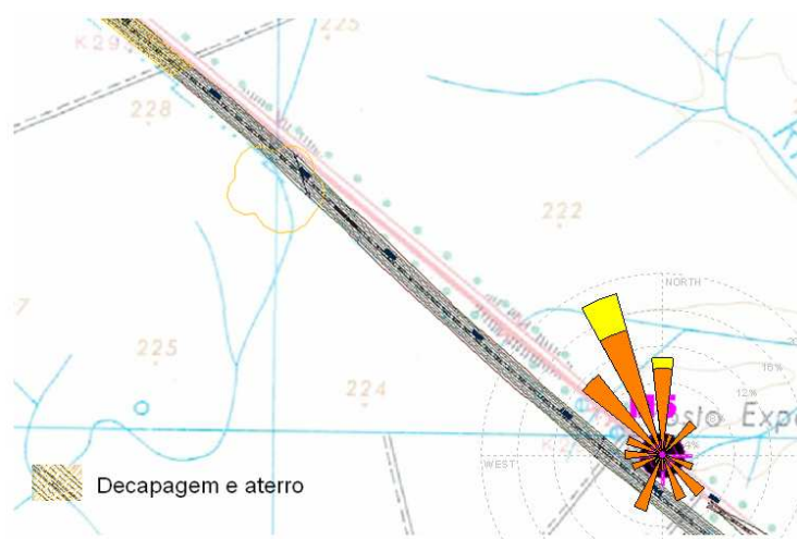
Figura 11 – Apresentação do regime de ventos durante a 1ª campanha face ao desenvolvimento das obras e ao local de medição M5.
